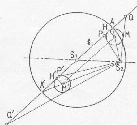
図2 作図定理1による卵形線の構図
