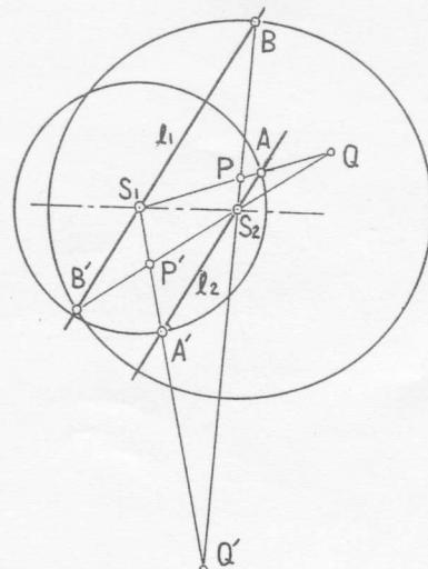
図3 作図定理2による卵形線の構図
